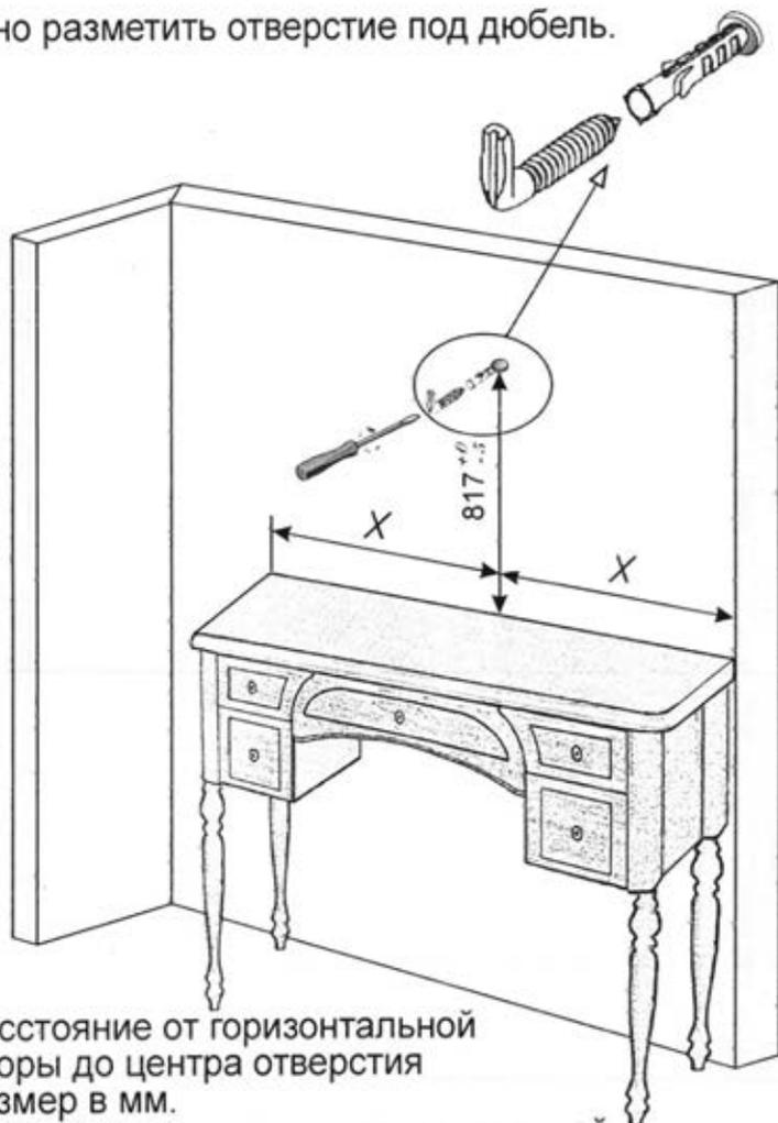
$817 \pm 0.5$  - расстояние от горизонтальной опоры до центра отверстия размер в мм.
